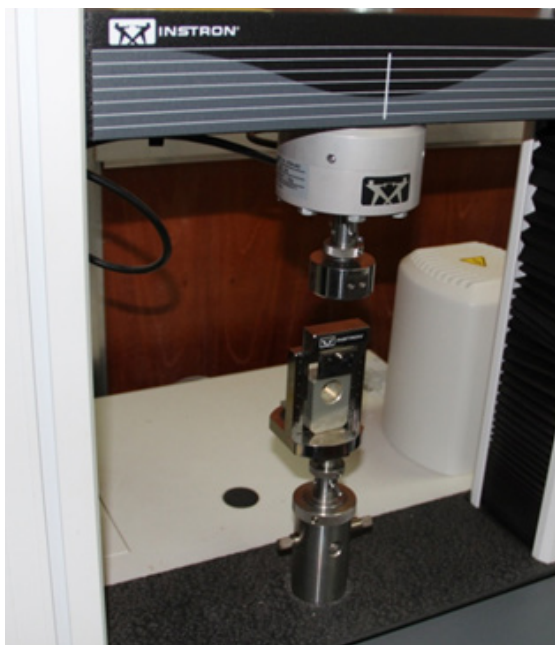
Figura 1. Máquina universal de ensayos Instron modelo 3366.
