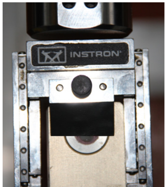
Figura 2. Prueba de cizalla con la máquina universal de ensayo Instron.
